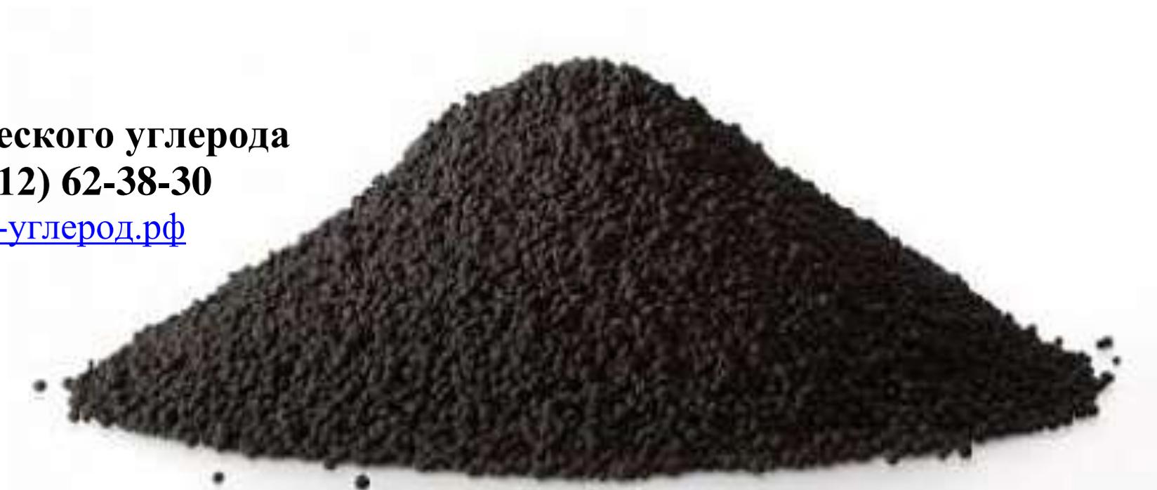
**Технический углерод, техуглерод, сажа (англ. Carbon black)** – высокодисперсный углеродистый материал, который образуется при неполном сгорании или термическом разложении углеводородов, содержащихся в природных или промышленных газах, а также в жидких продуктах нефтяного или каменноугольного происхождения.
