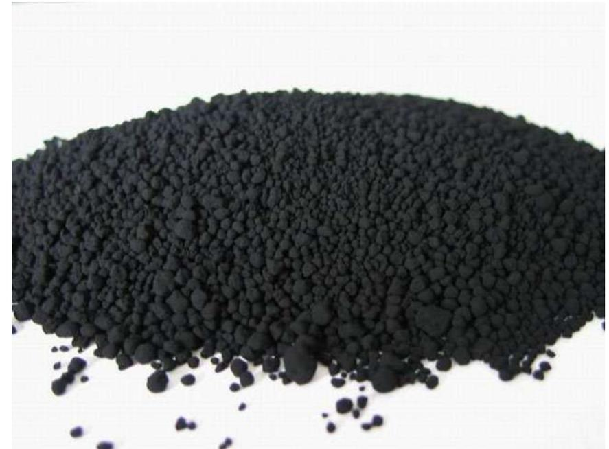
**Технический углерод П 514** – Печной, среднеактивный техуглерод, получаемый при термоокислительном разложении жидкого углеводородного сырья со средним показателем дисперсности и средним показателем структурности.
